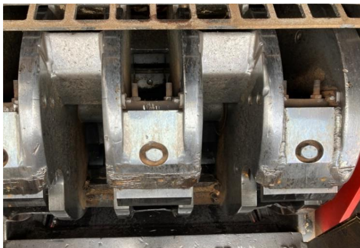
図 3-13 ウッドターミネーター9XL（クローラー式）の内部構造 (左：ドラム、右：スクリーン)
